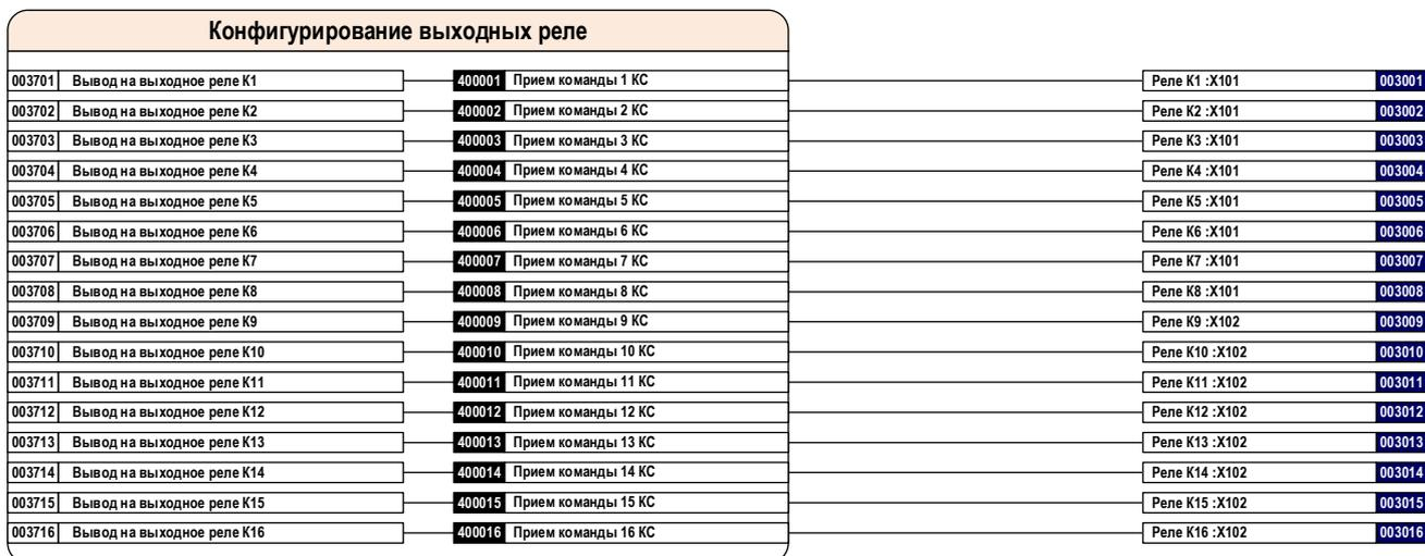
Рисунок 10. Конфигурирование выходных реле терминала
